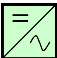
Figure 50 - Onduleur sans séparation galvanique du réseau
